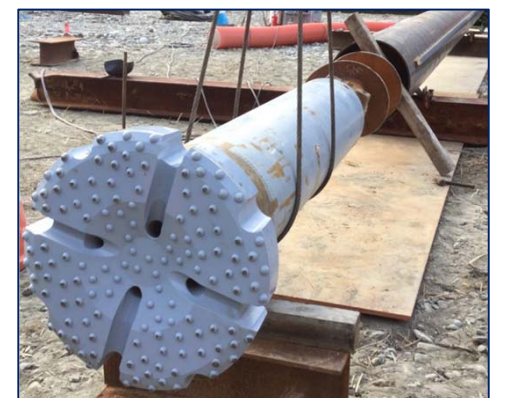
使用機械(ダウンザホールハンマー)
